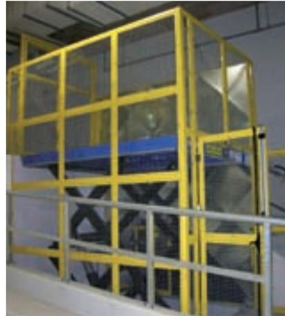
Lastentransport mit kundenseitiger Absicherung durch Schutzgitter und elektrisch verriegelter Türe
